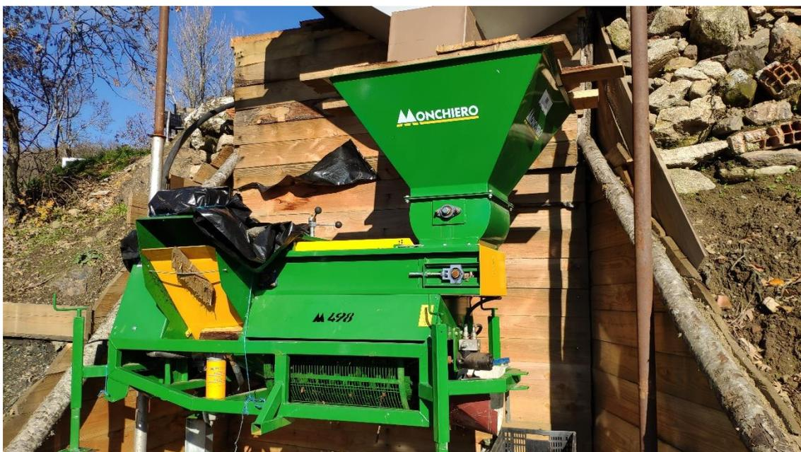
Figura 2- Máquina estática para limpeza de castanha.
