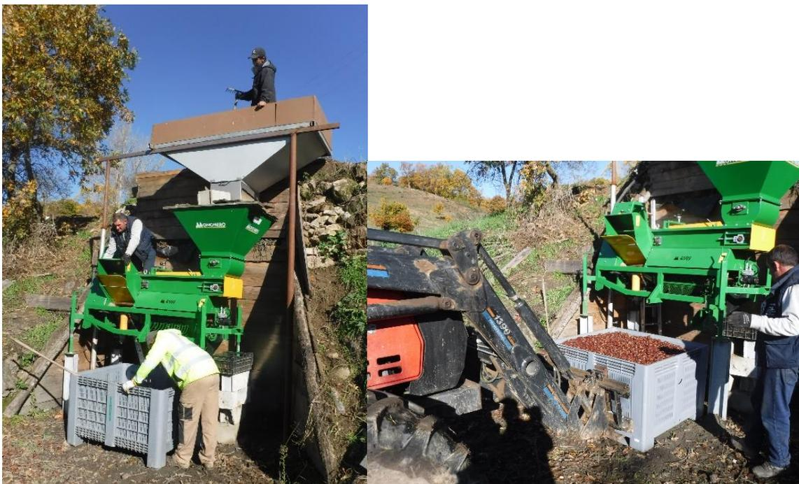
Figura 15– Testes para avaliação de desempenho de equipamento de limpeza e desourição em armazém
