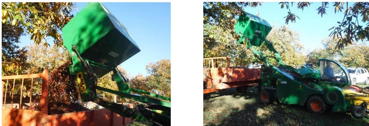
Figura 2– Testes de avaliação da velocidade de trabalho de equipamento automatizado de colheita por dispositivos exclusivamente mecânicos.
