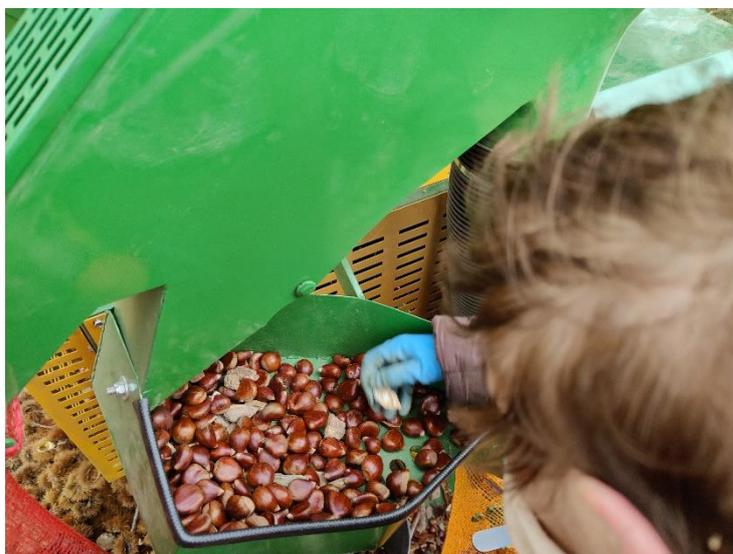
Figura 5- Aspeto das castanhas à saída da máquina, notando-se a presença de pedras de tamanho semelhante às castanhas.
