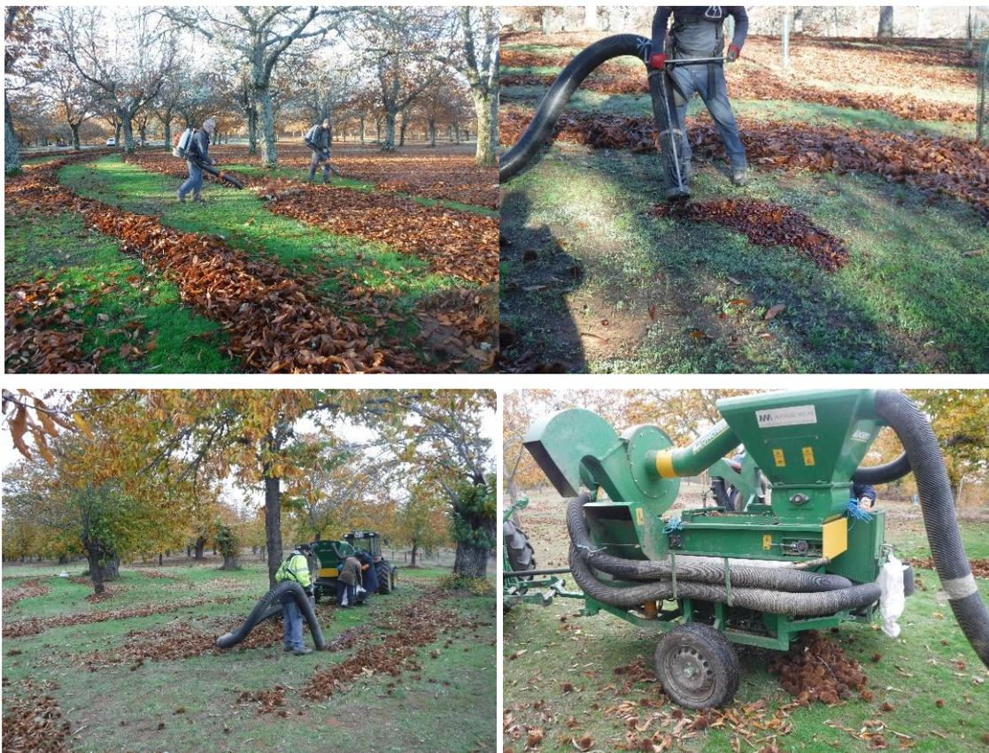
Figura 1– Testes para avaliação de desempenho de equipamento de colheita rebocado
