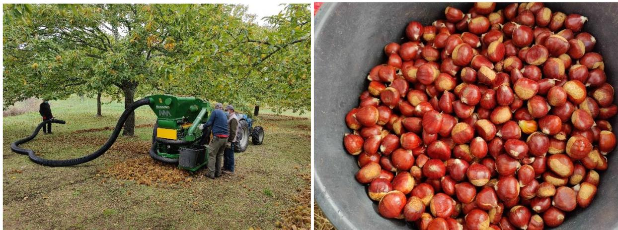
Figura 10- Máquina de apanha de castanha rebocada por trator e alimentada pela tomada de força do trator (esquerda) e lote de castanhas colhidas (direita).
