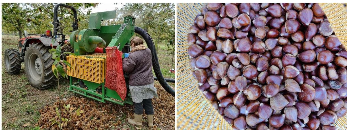
Figura 3- Máquina de apanha de castanha acoplada aos três pontos do trator (esquerda) e lote de castanhas colhidas (direita).
