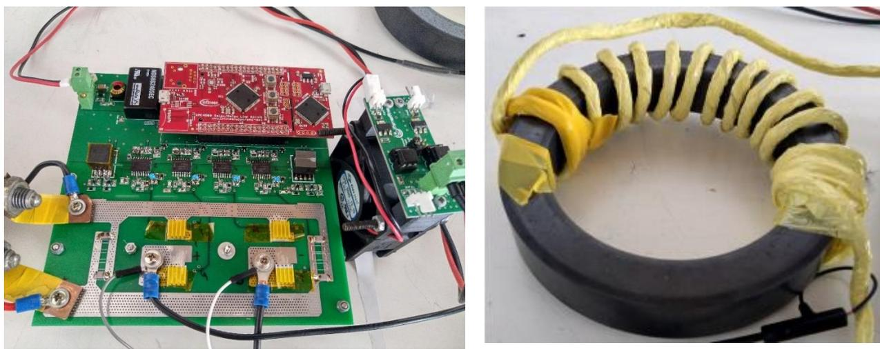
Figura 17- Placa de circuito impresso da ponte H e controlador (esquerda) e Bobine de ressonância (direita).
