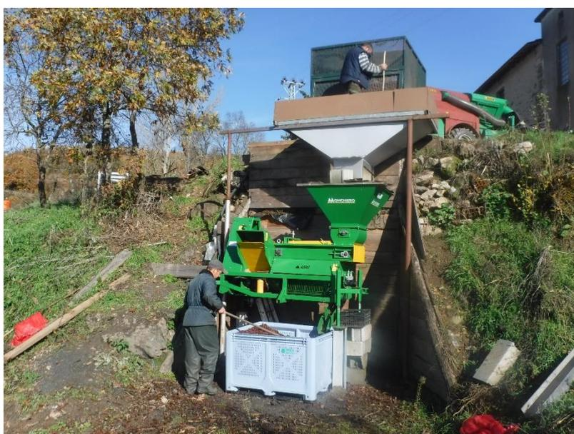
Figura 13- Equipamento de limpeza e desourização em armazém Monchiero 400
