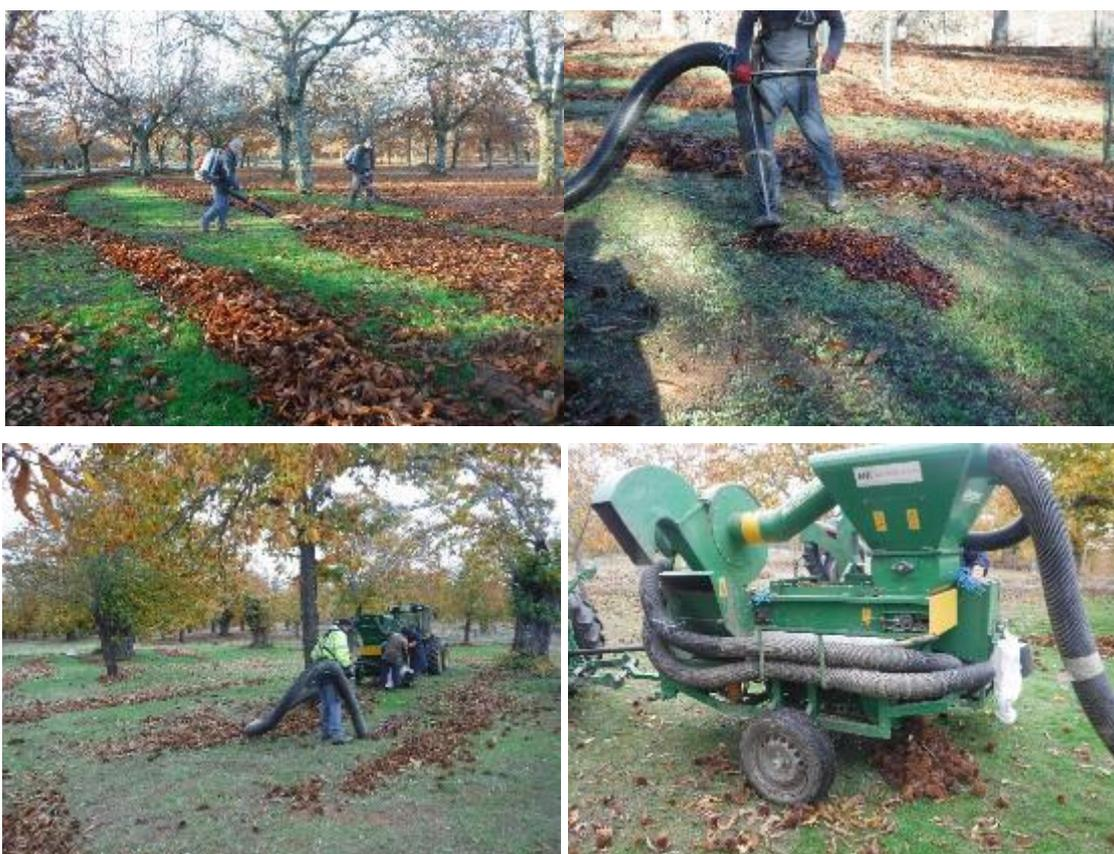
Figura 12– Testes para avaliação de desempenho de equipamento de colheita rebocado
