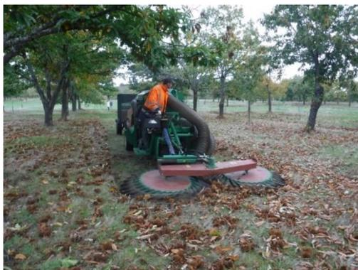
**Figura 2 - Equipamento de colheita automotriz Facma Cimina 380.**
