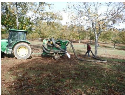
**Figura 4 - Equipamento rebocado de colheita por vácuo Monchiero 498.**
