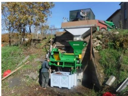
**Figura 5 - Equipamento de limpeza e desouraçamento em armazém Monchiero 400.**
