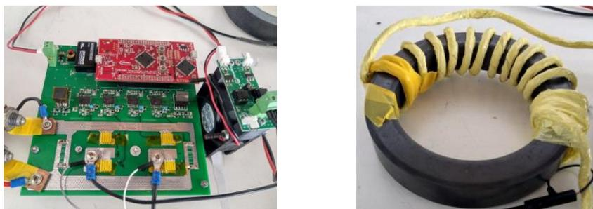
**Figura 1 - Placa de circuito impresso da ponte H e controlador (esquerda) e Bobine de ressonância (direita).**
