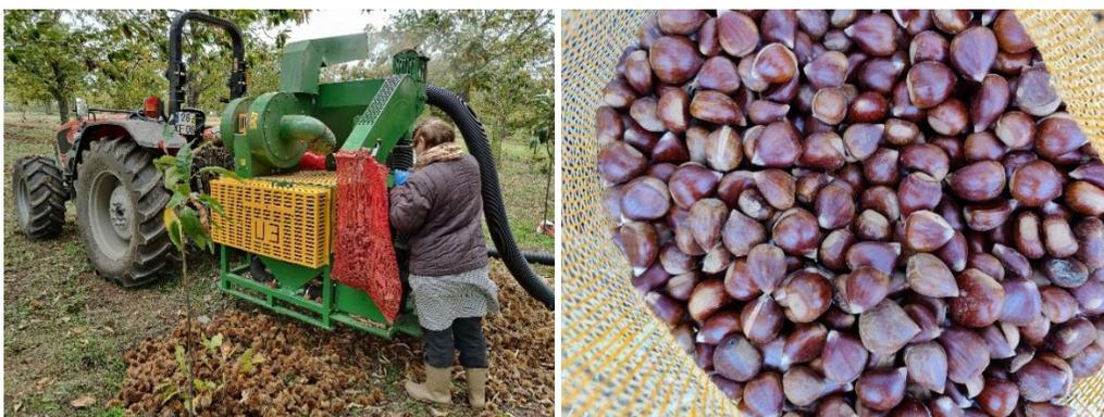
**Figura 1 - Máquina de apanha de castanha acoplada aos três pontos do trator (esquerda) e lote de castanhas colhidas (direita).**
