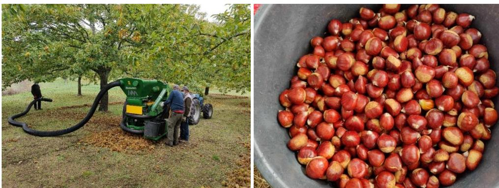
**Figura 8 - Máquina de apanha de castanha rebocada por trator e alimentada pela tomada de força do trator (esquerda) e lote de castanhas colhidas (direita).**
