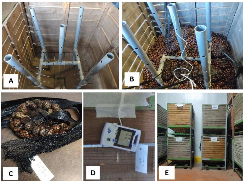
**Figura 8. Sistema de arejamento montado nas caixas palete de castanhas: A) sistema de tubos perfurados; B) colocação de sacos de amostras e *data loggers* no centro de massa da caixa palete; C) aspecto do saco de amostra (1 kg de castanhas); D) detalhe do *data logger*; E) armazenamento das caixas palete na câmara refrigerada.**
